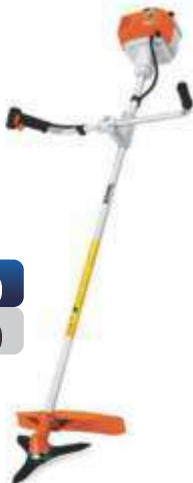
Desmalezadora Stihl FS-220 (14994) • Cilindrada 35,2 cm³ • Potencia 2,3 HP • Peso 7.7 Kg.
