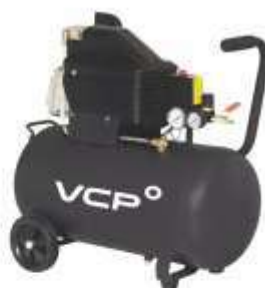
Compresor VCP VCH00020 2HP (39806) •Alimentación 1x220/50hz •2hp/1.500kw •Tanque 50 Lts. •Caudal 250l/min •115psi/8bar
